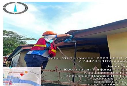
4. Pengujian kualitas udara dengan metode *passive sampler* di Terminal Bus Tanjungpandan
